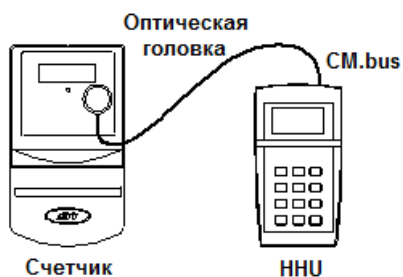
Рис. 4. Подключение модуля ННУ к счётчику.
